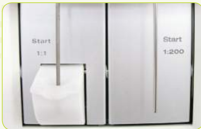
Sondas independentes para pipetagem (amostra normal e diluída)
